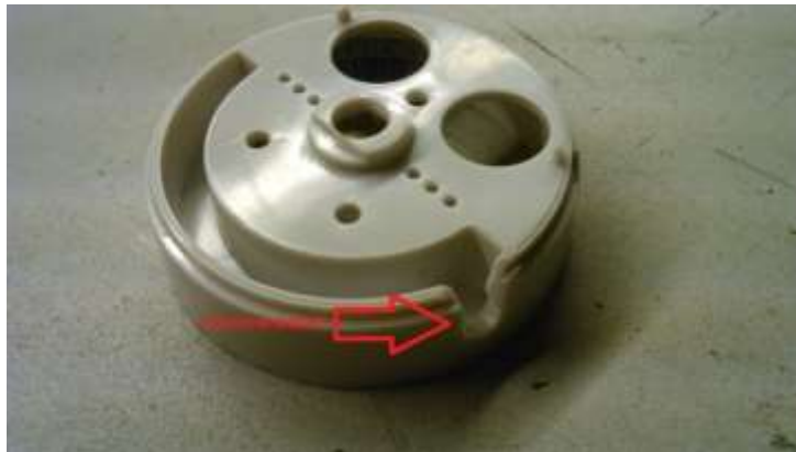
Kabeldurchführung beim NETATMO-Innenmodul
