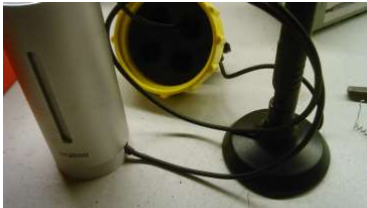
NETATMO-Innenmodul mit externer WLAN-Antenne
